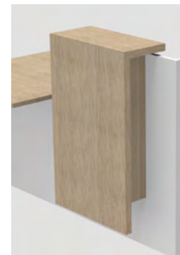
Parement installé avec entretoise
