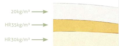
\*HR = haute résistance; indéformable et à haute récupération.
