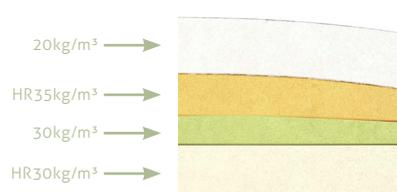
\*HR = haute résistance; indéformable et à haute récupération.
